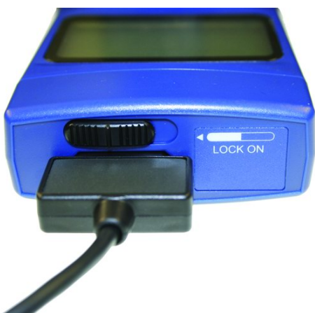
Abb. 5: Zum Arretieren des Sensorsteckers Schiebeschalter in linker Position
