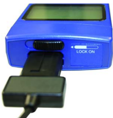
Afb. 28: Sensorstekker wordt erin gestoken, schuifschakelaar in de stand naar rechts
