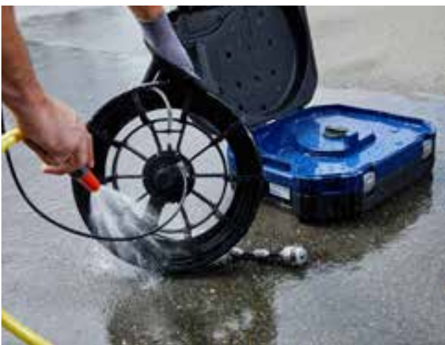
Nettoyage rapide et efficace de la mallette, l'enrouleur, le câble et la tête de caméra avec de l'eau.
