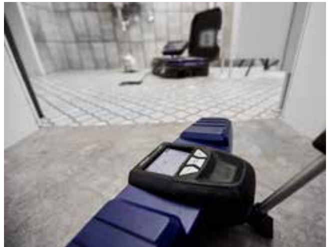
Possibilité de repérer exactement la tête de la caméra grâce au localisateur Wöhler L 200.
